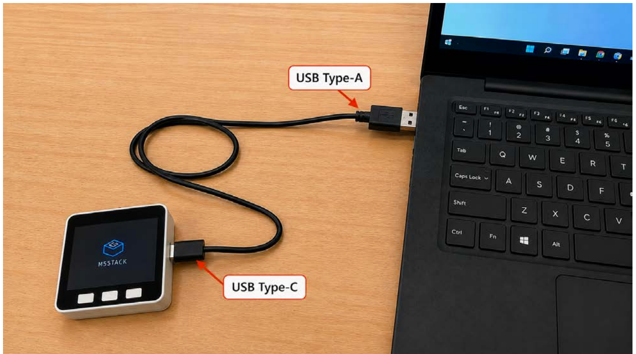
Abbildung 3.1: M5-Stack und PC-Verbindung über USB
